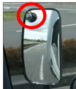
普通貨物車に取り付けた補助ミラーの例
